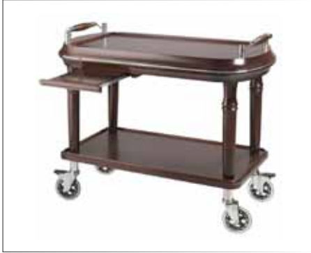
Servierwagen Mehrschichtholz/Edelstahl rostfrei 18/10 wengè ausziehbare Arbeitsfläche 4 bewegliche Lenkrollen antistatisches Gummi ca. 110x62 cm h 106 cm • Art. 116100
