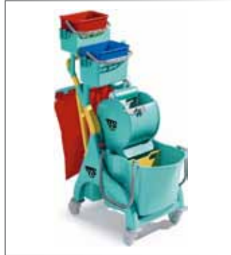
Reinigungswagen NICK PLUS 90 Fahrwagen aus Polypropylen mit 28 L. Eimer inkl. -„U“-Schiebegriff aus Kunststoff Dry Rollenpresse, grün Grundgestell mit Ø 80 mm Rollen und Stoßschutz, Halterung für Warnschild Eimerhalterung für Schiebegriff Zwei 4 Liter Eimer, rot/blau 2 Stielhalter, 50 l Sackhalter 43x79 cm h 112 cm Art. 104786
